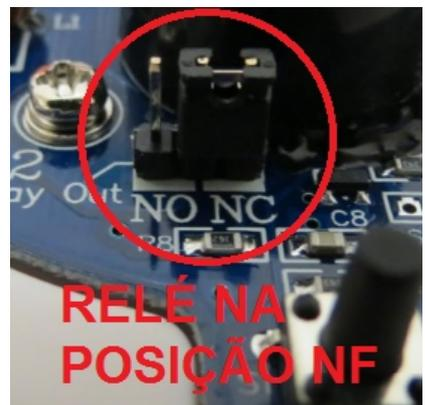
**ATENÇÃO:** Para realizar a ligação do sensor em conjunto com um módulo de endereçamento, o relé do detector deve estar na posição **NA (Normalmente Aberto)**
