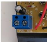
Para realizar a ligação da botoeira AFAM2 em conjunto com o laço proveniente da central AFVR8LS ou AFVR40L, deve-se abrir a central e encontrar seus bornes de ligação de laço.
