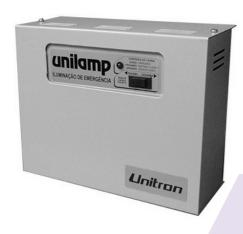
A central de iluminação de emergência é alimentada pela rede elétrica predial (110 ou 220 volts) e também possui alimentação por baterias, onde na falta de energia na rede elétrica predial, as baterias entram em funcionamento, comandadas pelo circuito eletrônico da central, enviando energia para as luminárias de emergência nela conectadas.
