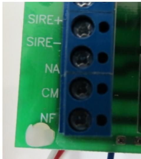
As sirenes são disparadas automaticamente quando a central de alarme de incêndio receber um sinal de emergência dos dispositivos periféricos (Detectores, Acionadores Manuais, etc). Se houver a necessidade de retardar o disparo das sirenes, veja na página 12 deste manual como configurar o temporizador de sirenes, pertencente à central de alarme de incêndio AFVR40L.
