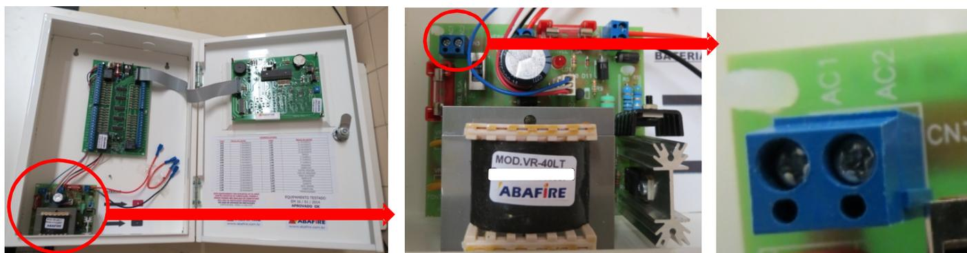
Após alimentar a central com energia proveniente da rede elétrica AC 110 Volts ou 220 Volts, ainda com a central de alarme de incêndio DESLIGADA, deve-se acoplar o par de baterias que vem junto com a central, seguindo os passos a seguir, conforme demonstra a figura abaixo.
